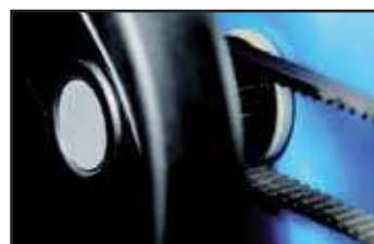
Avance del corte mediante correa de transmisión dentada.
