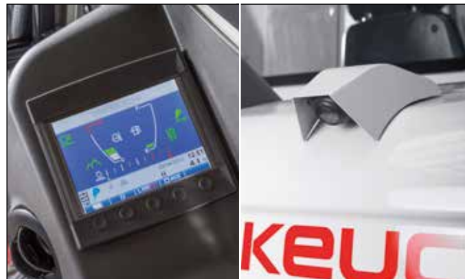
Display multifuncional, con visualización de la cámara de marcha atrás. Modo ECO para aumentar la rentabilidad y disminuir el consumo de gasoil.
