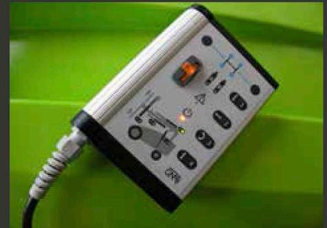
Panel de control con diseño de operador amigable con botones integrados. Las lámparas de señales y claves de seguridad dobles de acción son a la vez en la configuración estándar en el Winlet 350.
