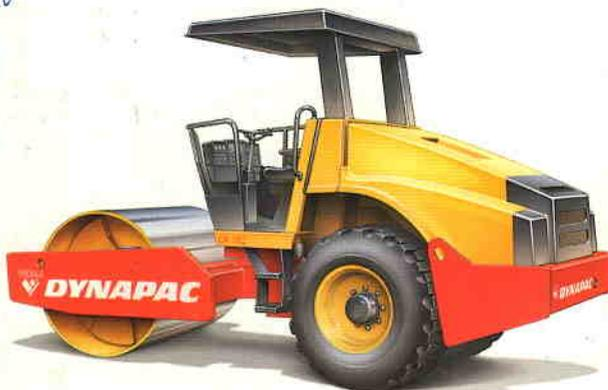
Un tamaño pequeño a mediano de compactador de suelos, apropiado para la compactación de arenas, gravas, limos y suelos limosos, bases y subbases. El tipo PD para arcillas y otros suelos cohesivos. Motor diesel Cummins.
