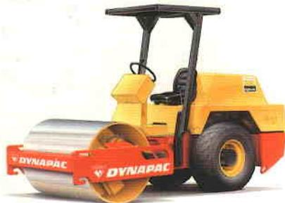
Un rodillo de tierras vibratorio, pequeño, adecuado para la compactación de arena, grava, barro y suelos limosos, subbases y bases. Máquinas PD para barro y otros suelos cohesivos. Motor diesel John Deere.
